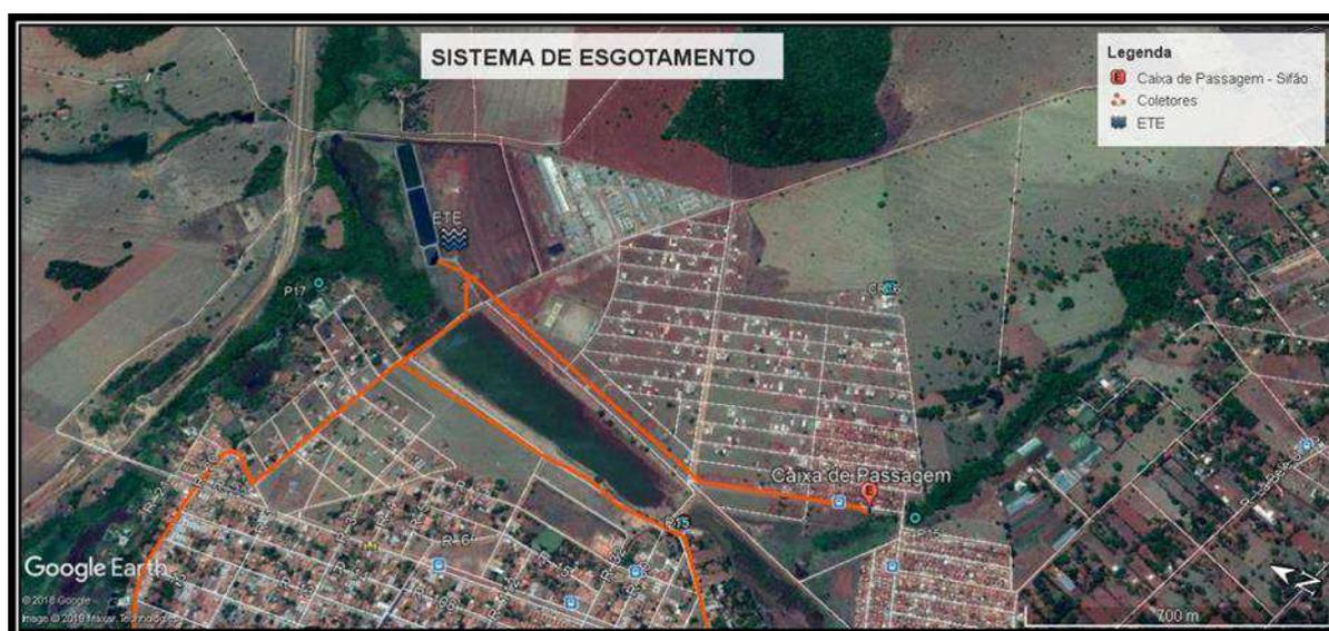
**Caixa de Passagem: Localizada na Av. L-13, esse sistema atende parte da região do Lago Azul, esse sistema conta com PV de chegada, retenção de sólidos e caixa de equalização e passagem (Sifão).**
