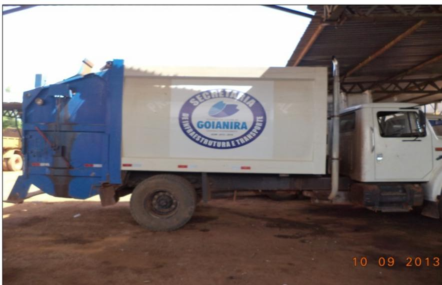
Figura 150 - Caminhão Compactador Utilizado para Coleta de Resíduos Sólidos Urbanos. Fonte: Hollus (2013).
