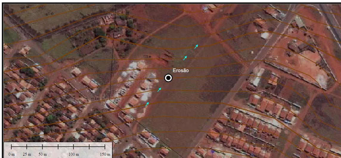
**Figura 144 - Localização de um ponto de erosão devido a falta de drenagem.**
